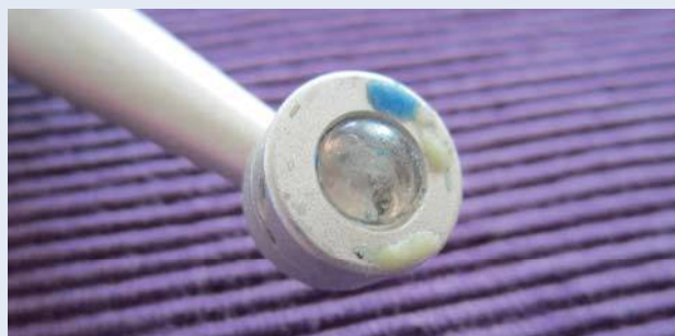
Ryc. 3. Zanieczyszczona głowica lampy. Lampa nie powinna być stosowana
