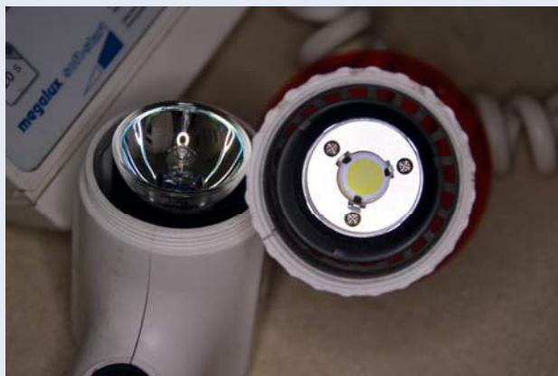
Ryc. 2. Żarówki lamp halogenowych powinny być wymieniane raz na 6 miesięcy. Elementy optyki zewnętrznej oraz wewnętrznej powinny być regularnie kontrolowane
